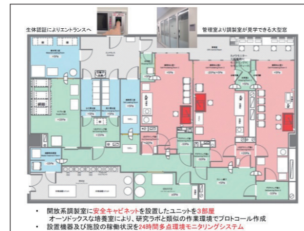
▲図3 キムリアの製造: CPFでのリンパ球の調製
